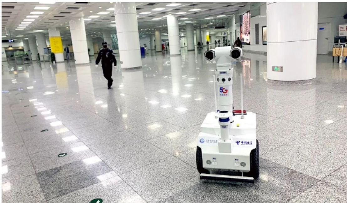
宁波轨道交通 1 号线鼓楼站 5G 智能巡检防疫机器人
